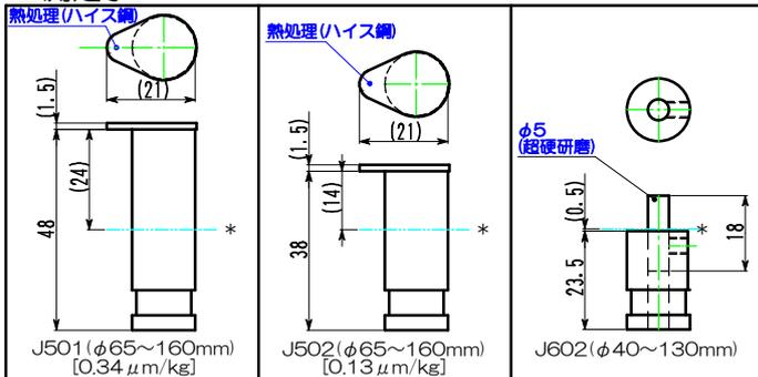
上図 ( ) 内の値は測定機本体がUK-150またはHMI-151と、測定子固定具の時の測定範囲です。外径測定の場合は異なります。
