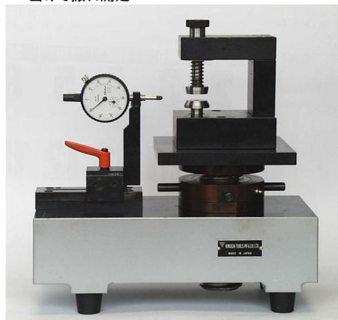
この例は JIS B1702 で規定される様な、平歯車及びはすば歯車の歯みぞの振れ測定用のユニットを本外径測定機に取り付けた例です。特別仕様品(歯車の軸穴を上下のテーパピンで挟んで測定、回転方向もベアリング入りでがた無く円滑です)
